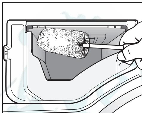
■ С помощью ёршика для мытья бутылок удалите остатки моющих средств и отложения извести с форсунок подачи воды в отсеке для моющих средств.
